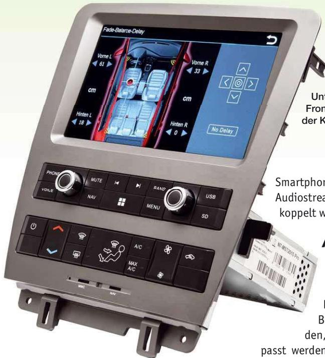
Unten in der passgenauen Frontplatte sitzen die Bedienelemente der Klimaautomatik
